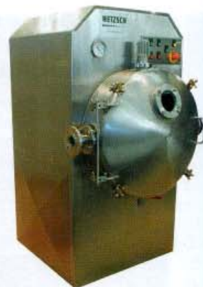
Der Mastermix ist ein vielseitiges Gerät zur Vakuum-entlüftung von Produkten in der Lebensmittelindustrie
